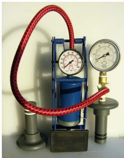
气泡试验测试装置（泵、压力表、适配器、配件等）示例照片。美国海德能不销售此装置。
