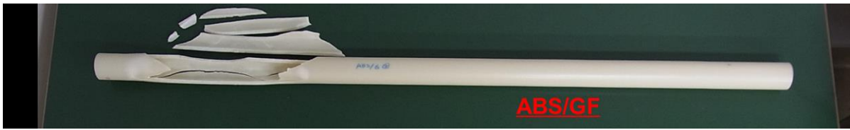
图 8 产水中心管破裂和机械损坏照片
